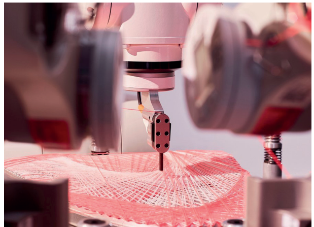
Figura 7: Prototipo de zapatilla FUTURECRAFT.STRUNG y robot multitarea en funcionamiento
